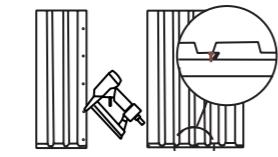
5. Lorsque vous assemblez les lames à l'angle du mur, joignez-les avec les rainures tournées l'une vers l'autre.
