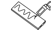
4. Les lames peuvent être assemblées verticalement ou horizontalement. Outre l'adhésif de montage, vous pouvez également utiliser une agrafeuse pour les fixer au mur. Appliquez les agrafes sur le bord de la rainure de la lame afin qu'elles soient
